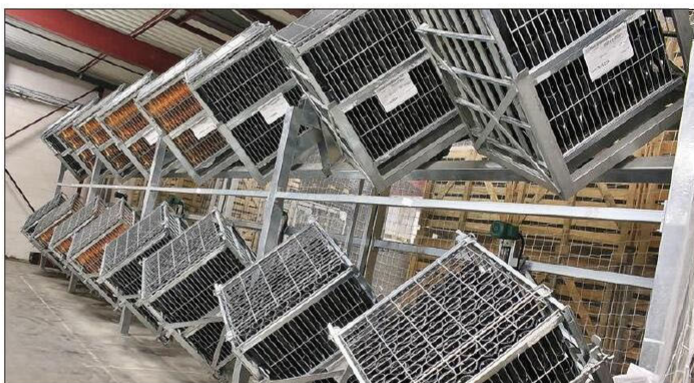
Les cages de remuage permettent de faire redescendre le dépôt dans le goulot en 48 heures. Photo LBP/M. D.
